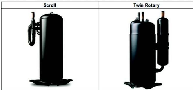
Compressori ermetici Scroll a spirale orbitante (rispettivamente per la 22 DC e la 33 DC) o Twin Rotary (per la 12 DC) completi di protezione del motore contro le sovratemperature, sovracorrenti e contro le temperature eccessive del gas di mandata.
