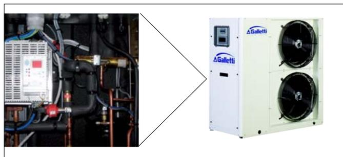
L'algoritmo PID di controllo consente di regolare la temperatura dell'acqua entro +/- 15%. Il controllo ad inverter oltre ad adeguare la potenza resa ed assorbita dal compressore all'effettivo carico termico consente anche una notevole riduzione dell'assorbimento elettrico all'avviamento del compressore stesso (riduzione delle correnti di avviamento).
