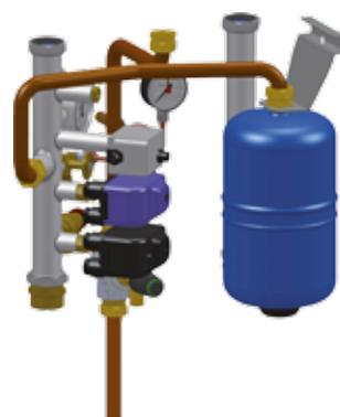
**ATTENZIONE:** il kit è completo di valvola di intercettazione del combustibile Ø1", pressostati di minima e di massima, valvola di sicurezza tarata a 6 bar, termostato di blocco, termometro, manometro completo di riccio e rubinetto, pozzetto ausiliare, raccordi da 1" 1/2, vaso di espansione da 5 litri.
