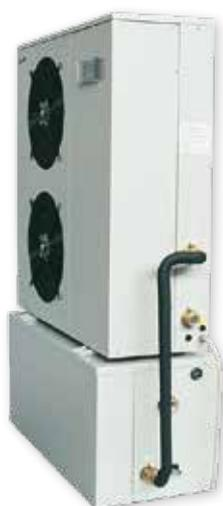
Il serbatoio di accumulo può essere abbinato ai refrigeratori **FRYO 9 - 10** e **POMPE DI CALORE 9 P - 10 P**. Il serbatoio ha una capacità di 70 litri, è in lamiera zincata di forte spessore e coibentato con poliuretano espanso spesso 20 mm.
