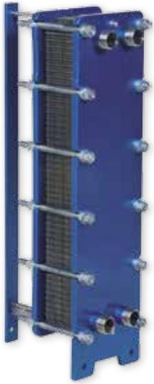
Scambiatori di calore per riscaldamento e produzione di acqua calda sanitaria (alberghi, ospedali, impianti sportivi, condomini, comunità, impianti solari). Le piastre sono lavorate e sagomate per ottenere la massima efficienza e accogliere le guarnizioni che hanno il vantaggio di non essere incollate e facilmente sostituibili e/o smontabili per la pulizia.
