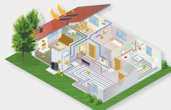
Il serbatoio di acqua tecnica assicura la produzione di acqua calda sanitaria in modo indiretto, grazie al serpentino in acciaio inox e permette l'integrazione di altri generatori termici, come termocamini o pannelli solari termici.
