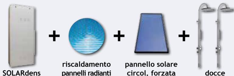
SOLARdens, dotato di kit I.A.R., utilizza il calore prodotto dal pannello solare per produrre acqua calda sanitaria e integrare l'impianto di riscaldamento. La caldaia entra in funzione solo quando l'energia fornita dal sole non è sufficiente a raggiungere le temperature impostate.
